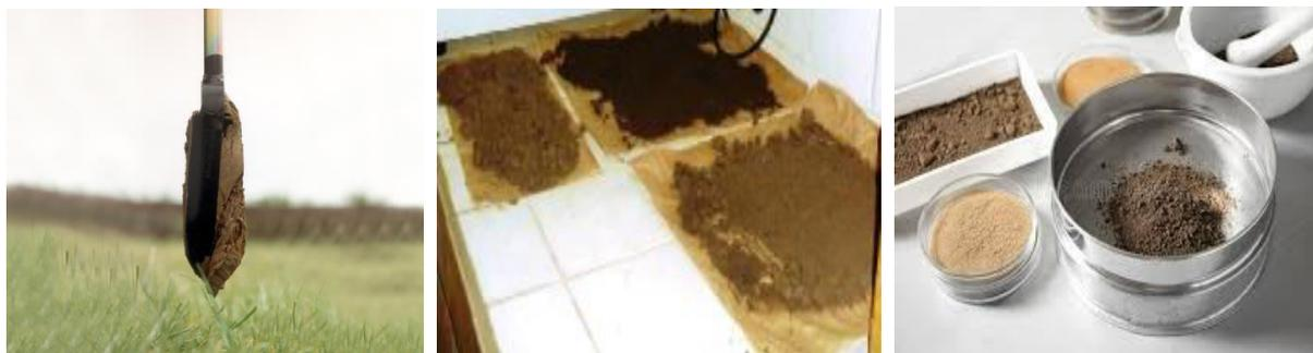
**Figure 09** : prélèvement et préparation des échantillons de sol.
